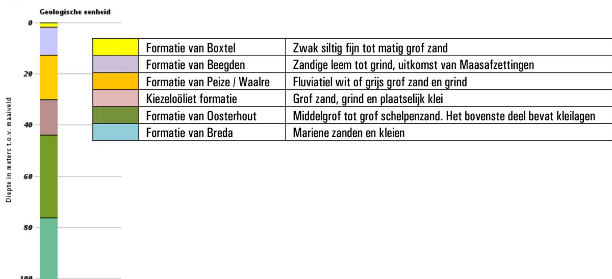
Figuur A: opbouw ondergrond.
