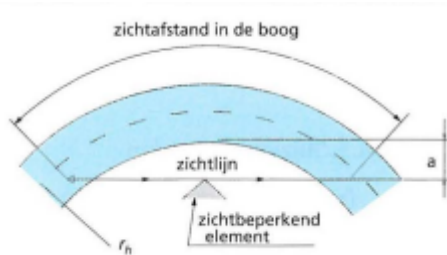
Figuur 11: Relatie tussen zichtafstand en horizontale boog, conform figuur 4.1 Handboek Wegontwerp Gebiedsontsluitingswegen 2013, CROW 330
